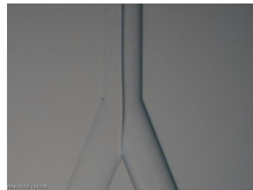
図 3 マイクロチップ上での水層 (右) -有機層 (左) の 2 溶媒による層流形成 (下 \rightarrow 上)。
